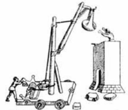
7.5 Baukran mit schwenkbarem Ausleger nach Taccola
