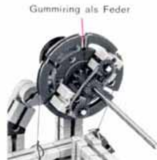
22.4 Baustufe 4 zu Modell 25.1 (2 Klinken mit Feder)
