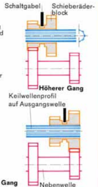
Bild 65.2 Schalten von Schieberädern
