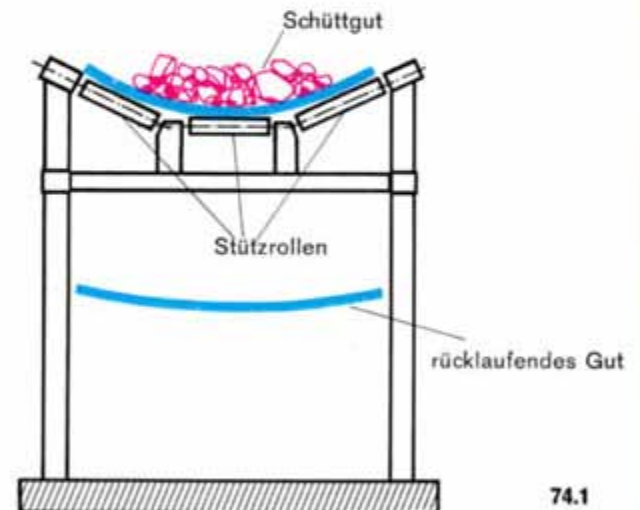
Schnitt durch eine Förderrinne
