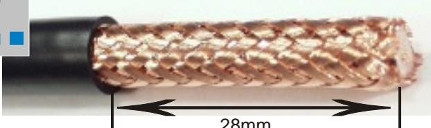
Mit dem Messer 28mm des PVC-Mantels entfernen.
