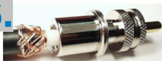
Steckerhülse auf das Kabelende schieben und das vorbereitete Kabelende in das Steckergehäuse einschrauben.
