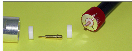
Bild 7: H2000 mit gekürztem Innenleiter und eingeschobenem Schaftkegel
