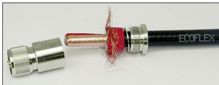
Bild 2: Der Schaftkegel ist zwischen Geflecht und Mantel zu schieben.
