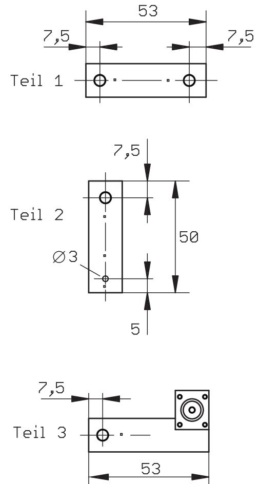
Abmessung der 70-cm-Fensterquad nach DL5ABF, FUNKAMATEUR 10/2013, S. 1092f.
