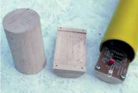
Bild 3: Halter für die Licht-Empfängerplatine
