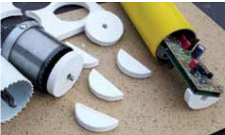
Bild 4: Halter für die Empfänger- und Sendeplatine
