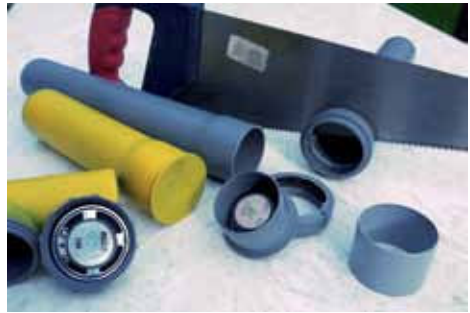
Bild 2: Entwässerungsrohre DN50 in der Bearbeitung
