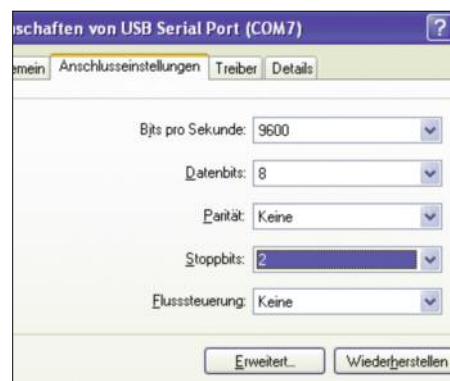
Bild 21: Eigenschaften-Dialogfeld; bei Anschlusseinstellungen 2 Stoppbits für Yaesu, 1 für Icom und 1 bzw. 2 für Kenwood
