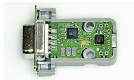
Bild 5: Die Sub-D9-Buchse ist so weit auf die Platine zu schieben, bis sie mit ihren seitlichen Befestigungslaschen plan an der Gehäusestirnseite anliegt.
