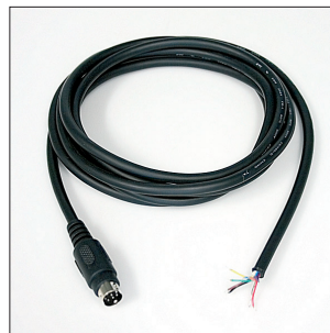
K-MDIN-ST8M: Kabel mit Mini-DIN-Stecker, 8-polig, männlich, Länge ca. 2 m, Rundkabel, alle Adern gemeinsam abgeschirmt, Schirm am Steckergehäuse
