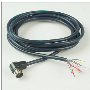
K-DIN-ST13M: Kabel mit DIN-Stecker, 13-polig, männlich, Länge ca. 1 m. Farben: 1-gn, 2-rt, 3-bn, 4-vi, 5-rt separat geschirmt, 6-ws, 7-Schirm von 5 und 9, 8-ge, 9-ws separat geschirmt, 10-or, 11-bl, 12-gr, 13-rs
