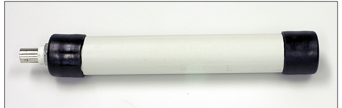
Bild 16: Ansicht der fertig montierten Aktivantenne
