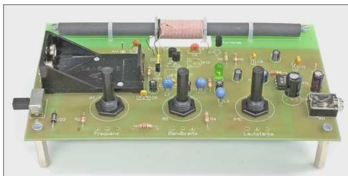
Bild 1: Ansicht Platine des MW-Einkreisers; die Potenziometer werden direkt in der Leiterplatte verschraubt.
