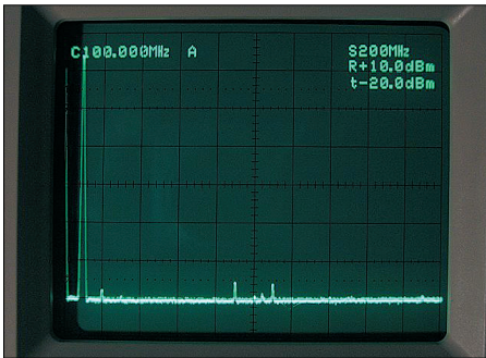
Bild A1: Ausgangsspektrum eines Signals bei 5 MHz, gemessen mit Hameg HM5014-2
