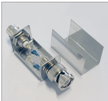
Bild 8: 50-Ω-Längswiderstand (zweimal 100 Ω parallel) im Weißblechgehäuse, FA-Nr. BX-068
