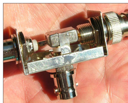
Bild 4: Eine Hand voll Koppler... Der breite Kupferstreifen bildet die Masseverbindung.
