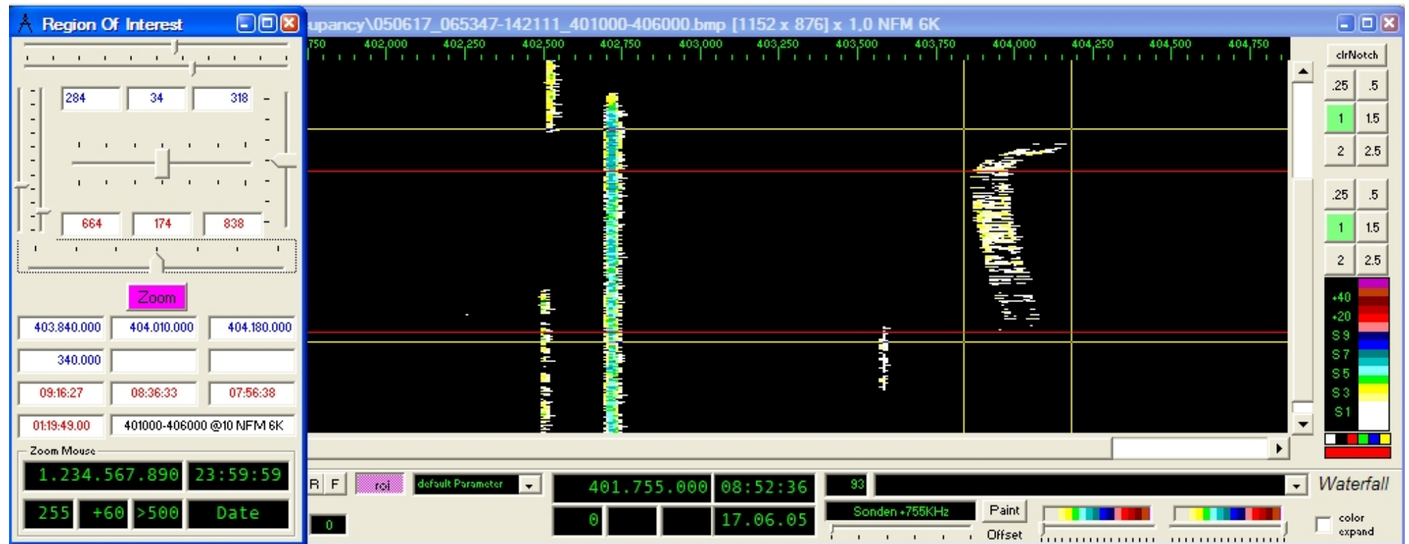
Abbildung Wasserfall: Bestimmung eines Auswahlfeldes (RoI)
