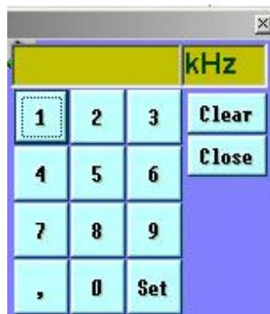
Eine weitere Eingabemöglichkeit besteht über ein integriertes Keypad. Dieses wird durch Anklicken der Schaltfläche Keypad aufgerufen. Über die Schaltflächen **1...0** können die Zahlen per Mausklick eingegeben werden. Über die Schaltfläche **Set** wird die eingegebene Frequenz in das Tuning-Menü übernommen und an den Empfänger übertragen. Die Schaltfläche **Clear** löscht alle Eingaben, die Schaltfläche **Close** schließt das Fenster.
