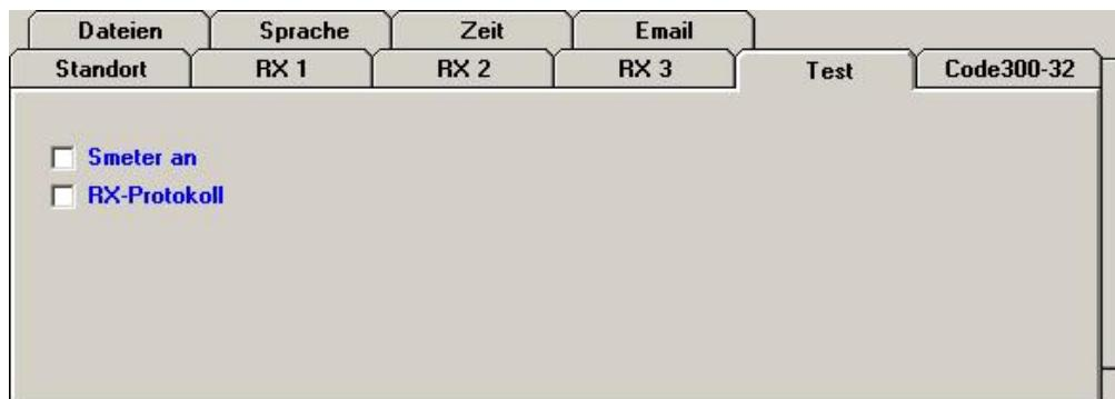
In diesem Test-Menü kann ausgewählt werden, ob das S-Meter eingeschaltet werden soll. Außerdem besteht die Möglichkeit, eine Protokoll-Datei C:\PCF\_Proto.txt zu erzeugen, die zur Analyse an uns eingeschickt werden kann.
