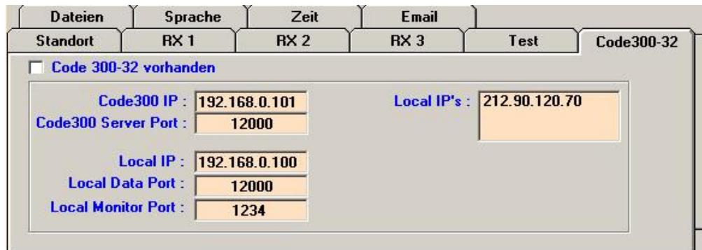
In diesem Menü werden die Ip-Adressen und Ports für die Fernsteuerung eines Code300-32 angegeben. Über das Fenster Local IP's werden die verwendeten IP's angezeigt, über die der Code300 gesteuert werden kann.
