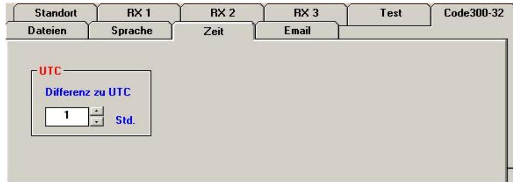
Über das Menü Konfigurieren wird das UTC-Fenster geöffnet. Hier kann eine Zeitdifferenz in Stunden zwischen der Zeit Ihres PC's und UTC angegeben werden. Der Frequenzmanager stellt dann die gewünschte Zeit dar.
