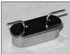
Bild 14: Die Quarzanschlüsse sind so zu kürzen und zu biegen, dass sie auf die Leiterbahnen aufgelötet werden können.
