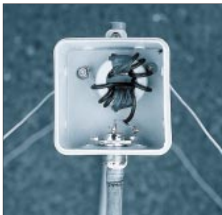
Bild 6: Der Anschlußkasten mit dem Balun
