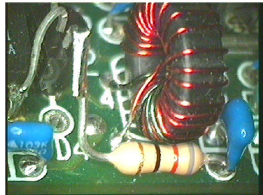
[ ] Löte einen 82 Ohm Widerstand zwischen den Emitter und PIN 1 von T2. Die Lötstelle von C11 lässt sich dazu gut benutzen.
