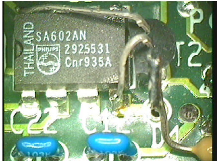
das SSB Quarzfilter weiterhin gegeben. Insgesamt resultiert aus dieser Änderung eine etwa 10 dB höhere Verstärkung.
