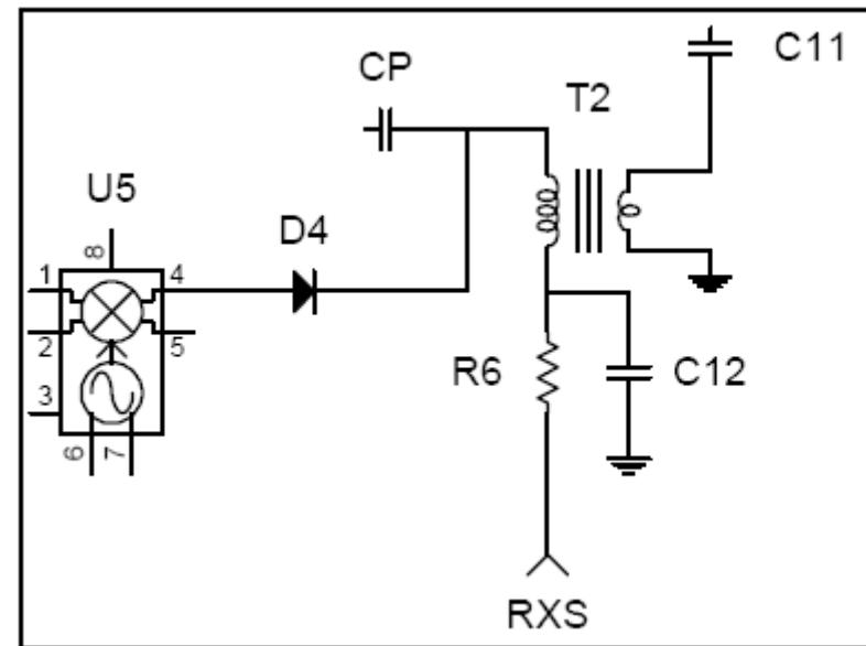
In der Zeichnung sehen wir die Originalbeschaltung im Bereich des NE602 Modulators. Bei der gegebenen Beschaltung wird das SSB Quarzfilter hochohmig gespeist. Die Ausgangsimpedanz des NE602 beträgt etwa 1500 Ohm, das Filter ist somit impedanzmäßig gut angepasst.
