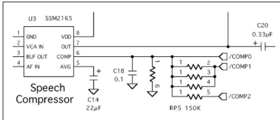
Die Modifikation ist denkbar einfach: Das Widerstandsnetzwerk RP5 besitzt im Original fünf Einzelwiderstände mit jeweils 47 kOhm. Es wird gegen 5 Einzelwiderstände von 150k ausgetauscht.
