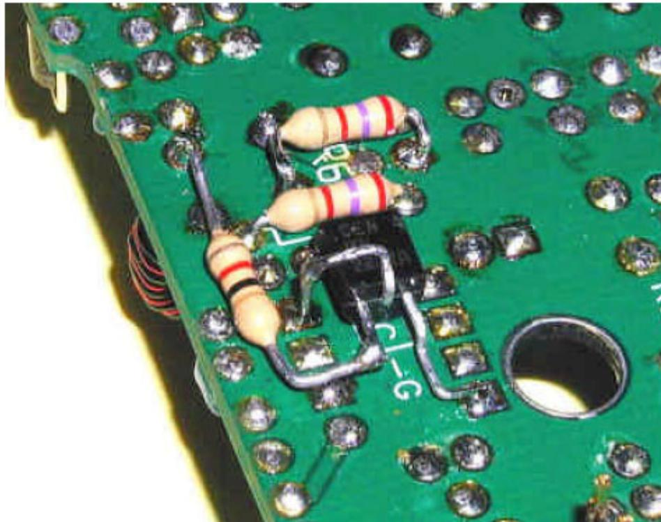
begrenzt die Spannung an der Basis-Emitter Verbindung des PN2222 auf 3V und verhindert so zuverlässig einen Basis-Emitter Durchbruch.
